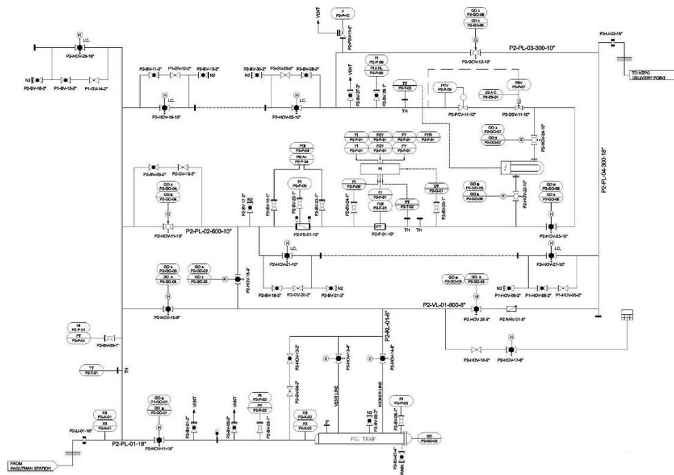
diagrama de tuberías e instrumentación (DTI) (piping and instrumentation diagram (P&ID)) de la estación de lanzamiento y recepción de raspa tubo (pipe pig)
